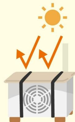
北陸では雪が降り積もることで室外機が雪に埋もれてしまい、外気を吸い込めなくなり運転冷媒ガスがスムーズに流れず、効率が低下することがあります。積雪で支障をきたさないよう、室外機の上や周囲を除雪する、防雪処置(屋根囲いなど)や室外機を嵩上げ設置するなどの工夫も必要です。
